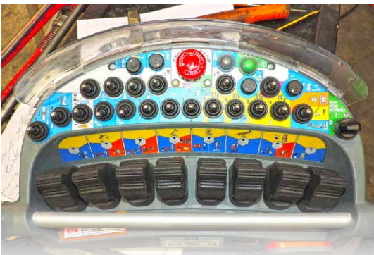
Radio comando per le funzioni di traslazione e perforazione Remote radio control for tramming and drilling functions
