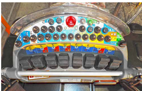
Radio comando per le funzioni di traslazione e perforazione Remote radio control for tramming and drilling functions
