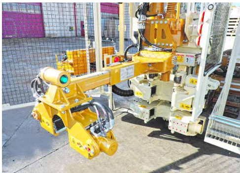
Braccetto carica aste su testa di rotazione. Diametro di presa: 45 - 220 mm Pipe loader arm on rotary head. Clamping range: 1" 3/4 - 8" 1/16 in
